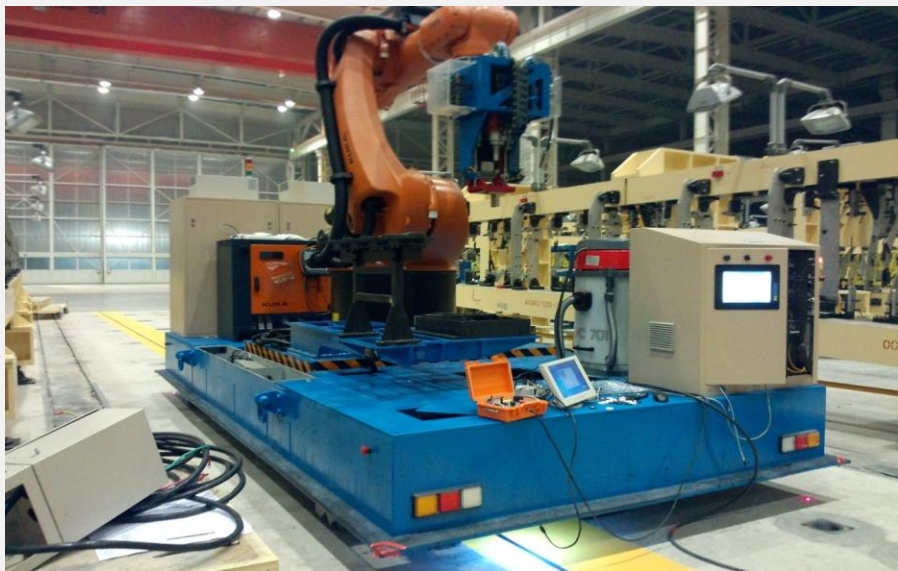
OMDP10T 飞机制造定位钻孔设备
